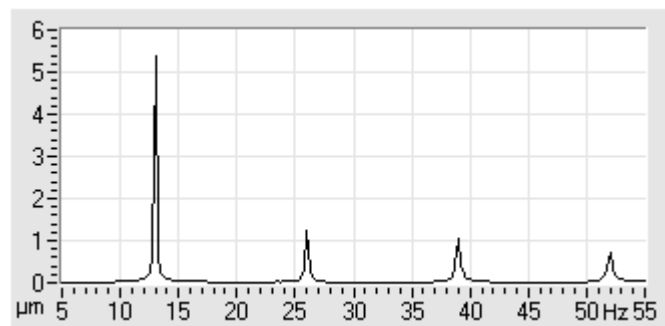
Fig. 31 : Amplitude spectrum of the shaft displacement s_{xu} , AMB and motor off
