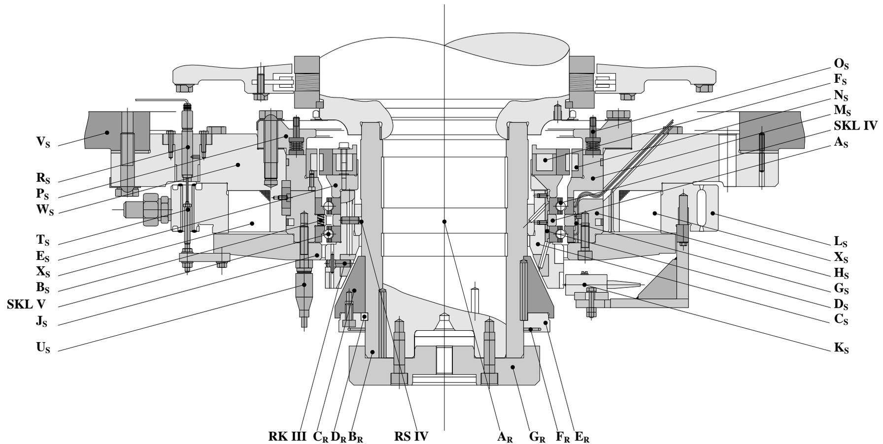
$A_R$  ... Vollwelle;  $B_R$  ... Wellenbüchse;  $C_R$  ... Zentrierring;  $D_R$  ... Sicherungsring 3-teilig;  $E_R$  ... Verschlußring;  $F_R$  ... Sicherungsring;  $G_R$  ... Klammerring
