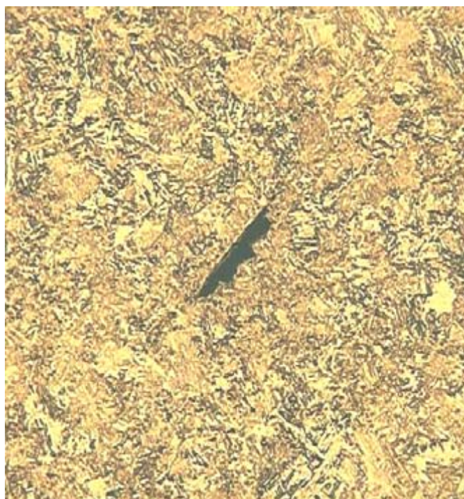
Indication n°1 length 225 \mu\text{m} - x 100
